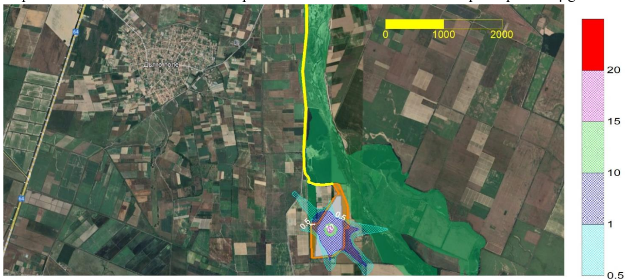
Фигура 4.1.1-4 – Годишно замърсяване ( \mu\text{g}/\text{m}^3 ) с \text{NO}_x от работа на техниката в добивното поле за една концесионна година в находище „Инджова върба - 3“
