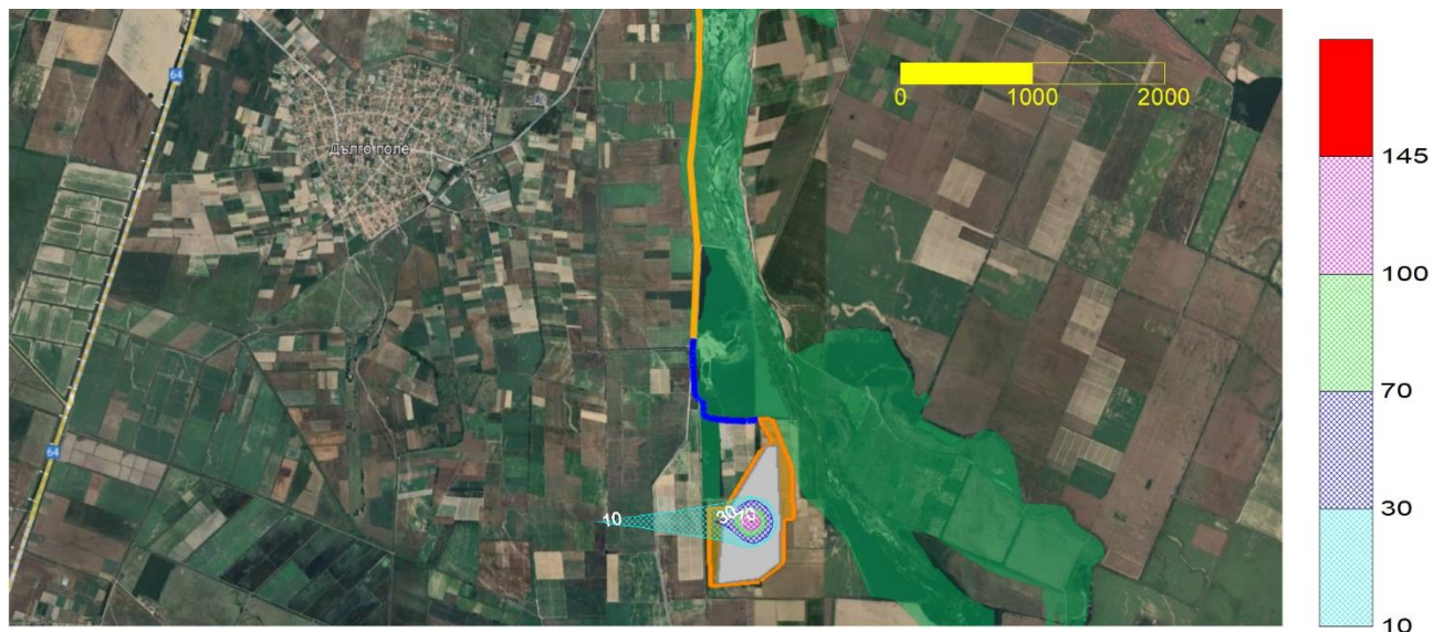
Фигура 4.1.1-6 - Еднократно поле на замърсяване ( \mu\text{g}/\text{m}^3 ) с \text{NO}_x от работа на техниката в добивното поле за една концесионна в находище „Инджова върба - 3“.
