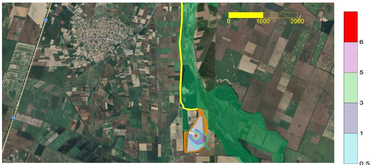
Фигура 4.1.1-3 – Годишно замърсяване ( \mu\text{g}/\text{m}^3 ) с ФПЧ 10 от дейностите по добив в добивното поле за една концесионна година в находище „Инджова върба - 3“.
