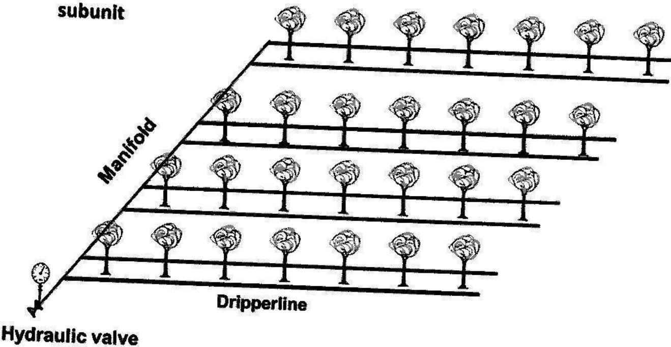
Поливните крила ще бъдат монтирани по два броя на всеки ред, на отстояние 1м от всяка страна на дръвчетата.
