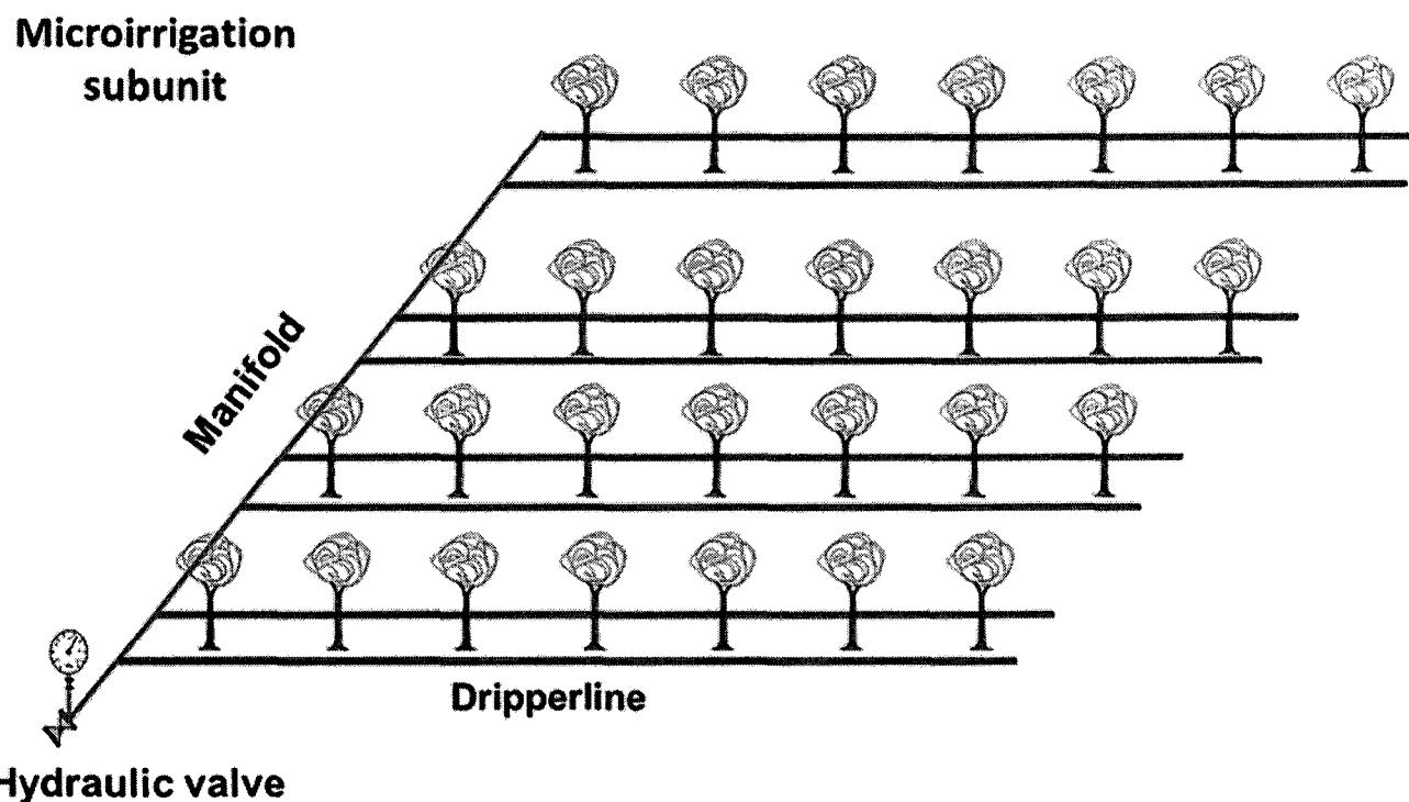
Поливните крила ще бъдат монтирани по два броя на всеки ред, на отстояние 1м от всяка страна на дръвчетата.
